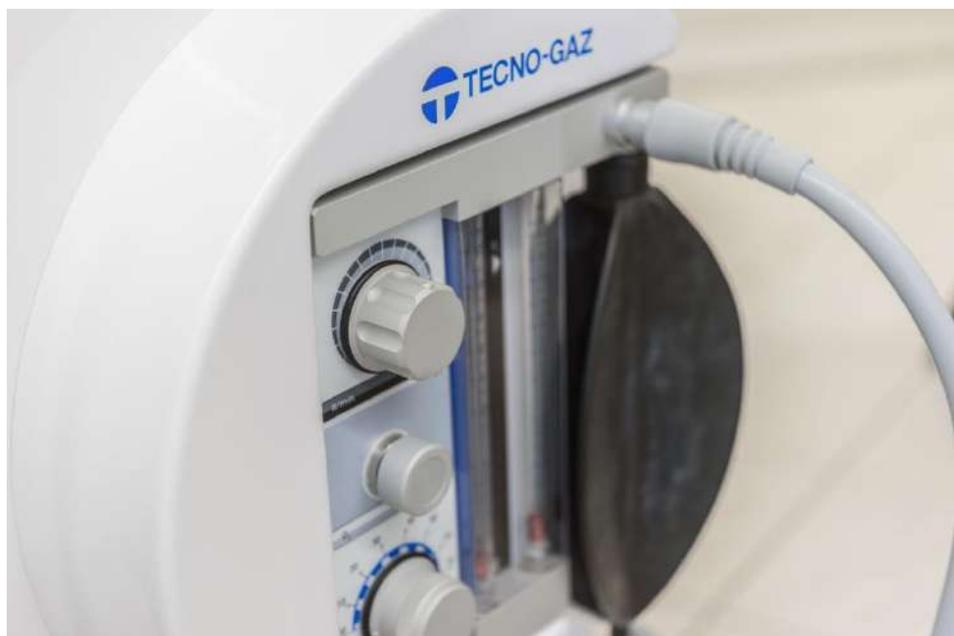
La scatola flussometrica è un sofisticato progetto di ingegneria meccanica con sistema di erogazione a proporzionamento automatico. E' stato prescelto il metodo meccanico in quanto la gestione dei gas è diretta e non subordinata ad altri dispositivi elettronici.
