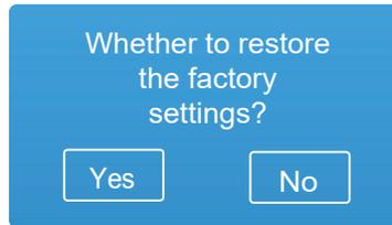
All'accensione, tenendo premuto il pedale (durante la fase di avvio), viene visualizzata a schermo la qui presente schermata. Selezionando l'opzione "YES" (si) , si accetta di cancellare qualsiasi parametro e programma impostato/memorizzato lato utente, ristabilendo i settaggi di fabbrica della macchina.
