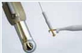
Connettere la pinzetta del rilevatore con il terminale dorato del cavetto di collegamento alla testina.
