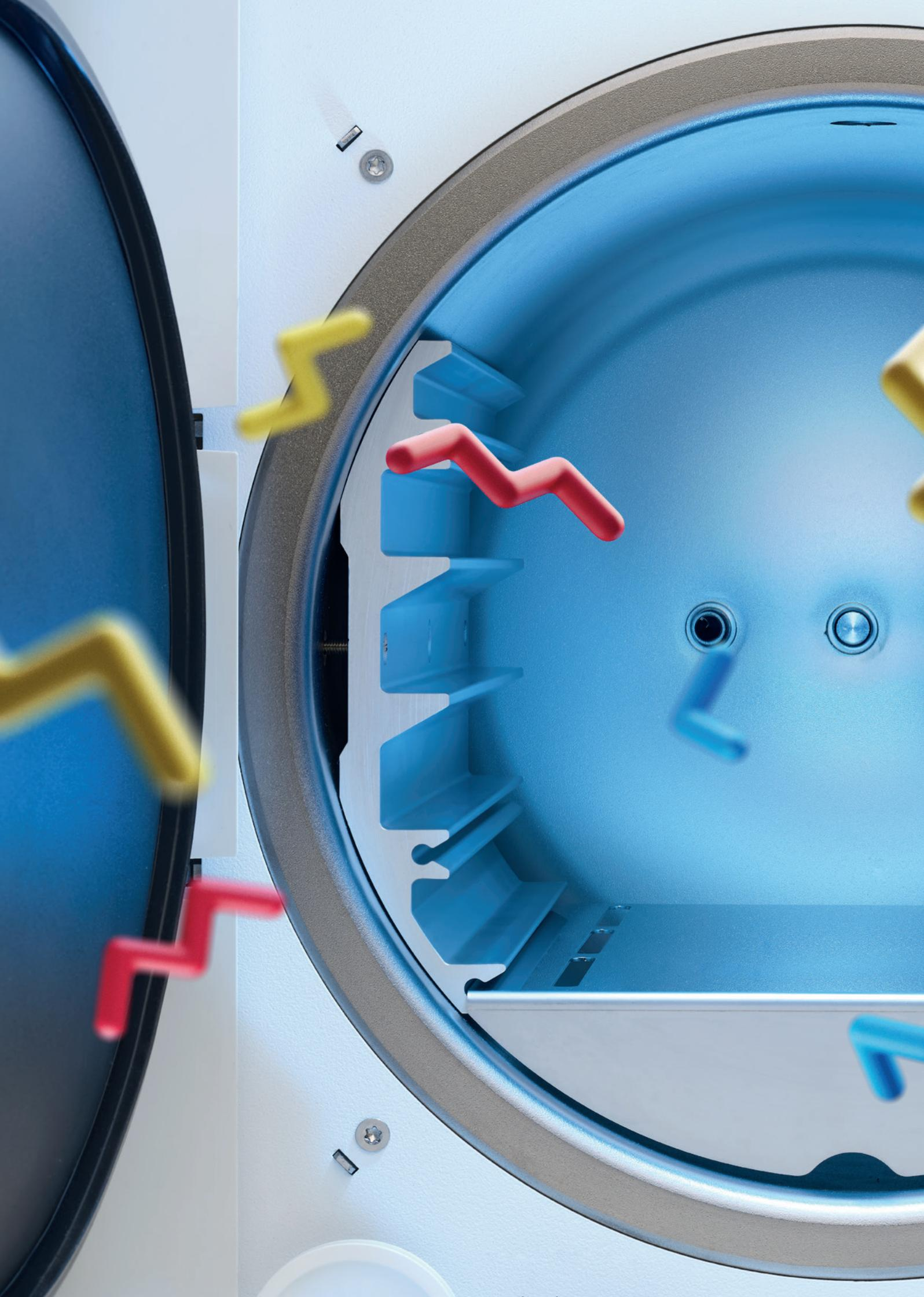
DXPclave è dotata di un innovativo sistema di distribuzione del vapore: l'autoclave inietta il vapore lateralmente rispetto alla camera, in posizione mediana e direttamente sui portavassoi, che fungono da accumulatori di calore.
