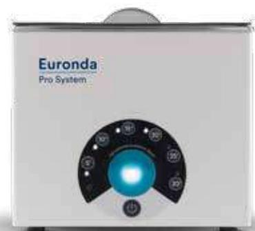
Vasca ad ultrasuoni digitale, caratterizzata da una temperatura di lavoro costante a 60°C e tempo regolabile 0-30 minuti, attraverso il controller centrale retroilluminato. Eurosonic® 3D funziona con Sweep Mode Technology che distribuisce omogeneamente le onde ultrasoniche per una pulizia più uniforme. Inoltre è dotato di un count down visivo del ciclo, grazie ai LED che circondano il controller frontale.
